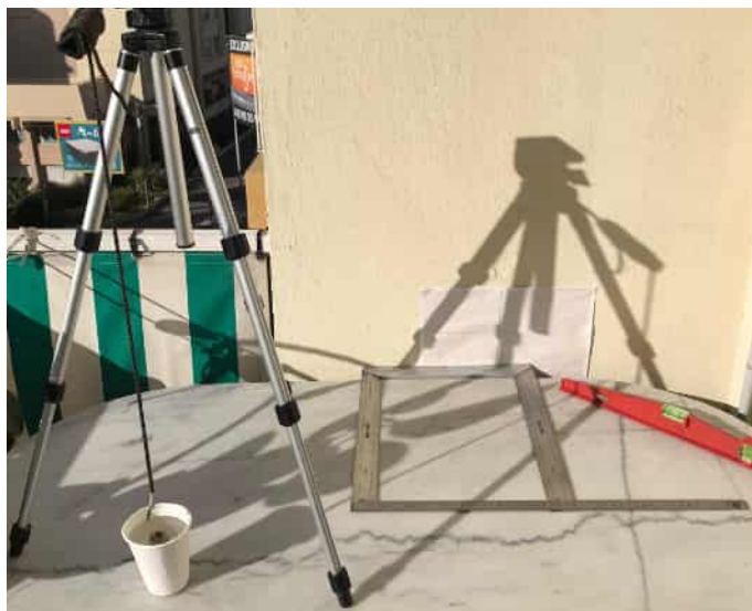
FIGURE 3 – Dispositif de la variante "A" de la méthode de la planchette.
