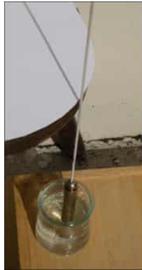
FIGURE 13 – Le fil à plomb au plus prêt d'une planchette permet d'obtenir une ombre portée de qualité sur environ 20 cm (Photo Ph Sauvageot).
