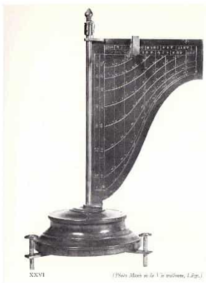
FIGURE 7 – Cadran de hauteur avec diagramme du cadran de berger déroulé sur un plan.
